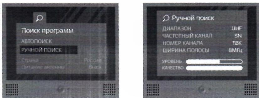
В меню перейдите к разделу настройка каналов. Выберите «Ручной поиск» - необходимо ввести номер канала или частоту. Введите: Диапазон — UHF; Частотный канал — SN; Номер телевизионного канала (ТВК); Ширина полосы (или полоса пропуска) — 8 МГц.
